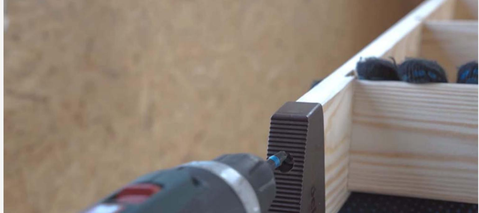
Осталось только отрегулировать угол наклона лестницы с помощью ограничителя хода. Максимальный диапазон регулировки винта в 8 мм позволит отрегулировать высоту ножек в диапазоне. В идеале на стыках секций разложенной лестницы не должно оставаться зазоров, а ножки должны твердо стоять на напольном покрытии. Если это так, то лестница установлена правильно.
