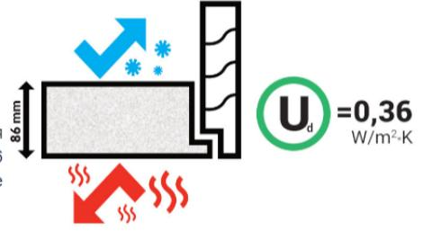
**Высокая энергоэффективность крышки люка.** Чем ниже показатель теплопроводности  $U$ , тем выше тепловая мощность люка, тем меньше потерь тепла через отверстие в потолке. Продукция POLAR имеет люк толщиной 86 мм, который в настоящее время является **самым теплым** на рынке. Теплоизолирующие материалы применяемые при его производстве, гарантирует низкую теплопередачу.
