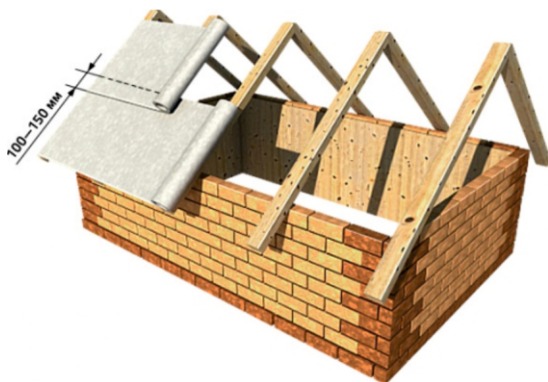
Рисунок 3 Способ укладки гидроизоляционной пленки
